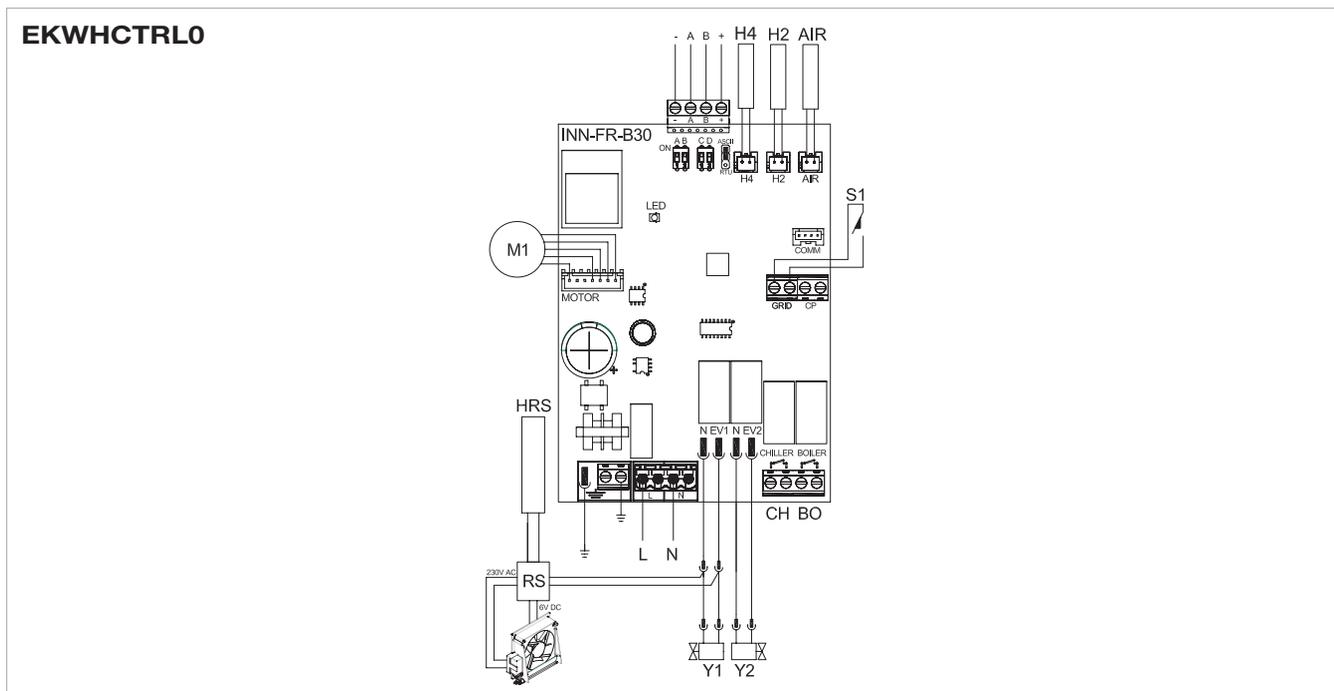
I 4 morsetti a molla (rif. A) destinati alla connessione del controllo a muro EKWHCTRL1 accettano cavi rigidi o flessibili con sezione da 0,2 a 1,5 mm<sup>2</sup> (0,75 mm<sup>2</sup> se si collegano 2 conduttori nello stesso morsetto), mentre se gli stessi sono dotati di capocorda con collare in plastica la sezione massima è di 0,75 mm<sup>2</sup>.
